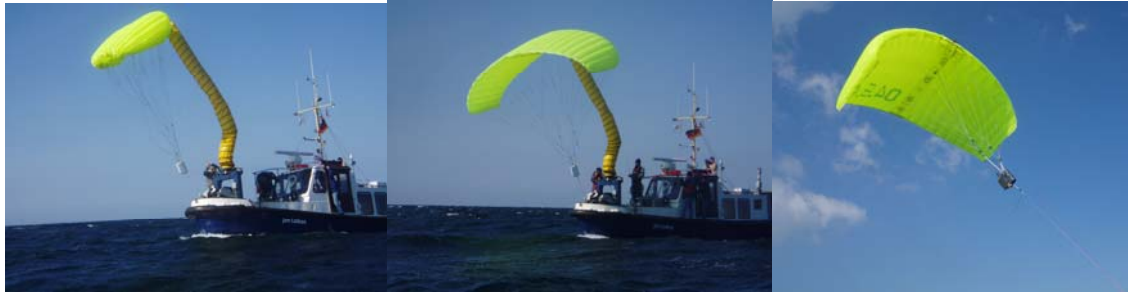
Oben: Start des Zugdrachens auf den Versuchsträger "Jan Luiken"
